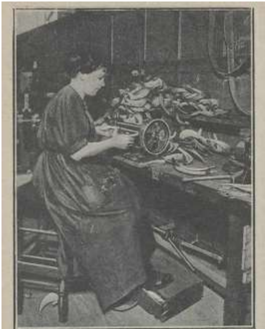
ON VOIT ICI UNE OUVRIÈRE PROCÉDANT A LA FABRICATION DES VISIÈRES ET DES COUVRE-NUQUE AU MOYEN D'UN LAMINOIR
