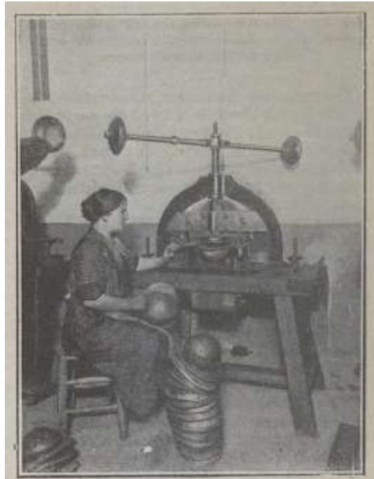
SERTISSAGE DE LA VISIÈRE ET DU COUVRE-NUQUE SOUS LE JONC DE LA BOMBE A L'AIDE D'UNE PRESSE A BALANCIER
